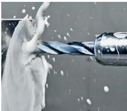
XTREME GRIND 321 ne sadrži nikakva naftna ulja, što ga čini ekološki prihvatljivim. Ova emulzija pruža odličan proces zaštite od korozije, dijelovima mašina i alatnih strojeva. XTREME GRIND 321 radi izuzetno čisto, ima odličan biootpor i praktično ne pjeni. Proizvod je formulisiran sa prihvatljivim tenzidima, ima dobro svojstvo ispiranja, smanjuje (redukuje) ciklus i poboljšava hlađenje alata i dijela koji se obrađuje. XTREME GRIND 321 se može koristiti i za lakše mašinske obrade.
