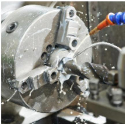
Q-CUT 214 je polusintetička tečnost za obradu obojenih i neobojenih metala. Q-CUT 214 je bez hlora i dizajniran je za lakše i umjerene primjene.
