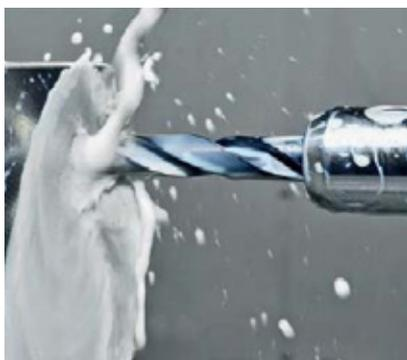
XTREME GRIND 321 ne sadrži nikakva naftna ulja, što ga čini ekološki prihvatljivim. Ova emulzija pruža odličan proces zaštite od korozije, dijelovima mašina i alatnih strojeva. XTREME GRIND 321 radi izuzetno čisto, ima odličan biootpor i praktično ne pjeni. Proizvod je formuliran sa prihvatljivim tenzidima, ima dobro svojstvo ispiranja, smanjuje (redukuje) ciklus i poboljšava hlađenje alata i dijela koji se obrađuje. XTREME GRIND 321 se može koristiti i za lakše mašinske obrade.
