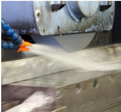
XTREME GRIND 321 je potpuno sintetička tekućina za brušenje i rezanje dizajnirana za upotrebu na obojenim i drugim metalima.
