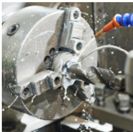
Q-EXTRUDE 5265 i Q-EXTRUDE 6580 su dvonamjenske tekućine na bazi čistog ulja bez vode, osmišljene za učinkovito podmazivanje u procesu oblikovanja dijelova, kao i samih mašina-strojeva. Upotrebljavaju se u radu sa materijalima od željeza i aluminijuma.
