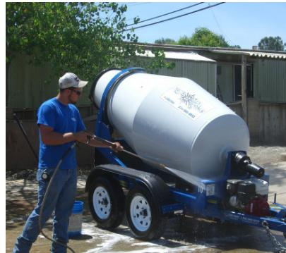
**Primjena:** BETOS LX 30 djeluje slojevito tako da je potrebno nanijeti vodu pa sredstvo i to isključivo odozdo prema gore, a po potrebi ponavljati postupak. Nakon tretmana obavezno dobro isprati vodom. Može se primjenjivati u zatvorenim sistemima gdje je moguć protok (mašinski), ostaviti da sredstvo djeluje, provjeriti sistem i po potrebi ponoviti postupak. Mjeriti ph vrijednost.
