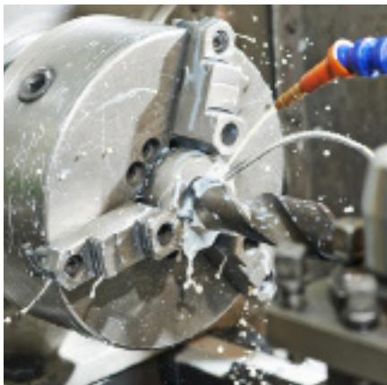
Q-CUT 214 je polusintetička tečnost za obradu obojenih i neobojenih metala. Q-CUT 214 je bez hlora i dizajniran je za lakše i umjerene primjene. Tipične operacije obuhvataju mnoge vrste obrade, bušenja, glodanja, tokarske obrade, urezivanje i sl. Tečnost stvara stabilnu emulziju u tvrdoj i mekoj vodi i pokazuje dobru stabilnost do 30 °dH tvrdoće. Proizvod ima dobru biološku otpornost kako bi se osigurao dug fluidni život. To znači da sadrži puni paket aditiva koji omogućuju dugotrajnost.
