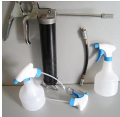
Ručna tlačna pumpa za mast je isključivo prilagođena za masti koje su pakovne u tubama od 400 grama.
